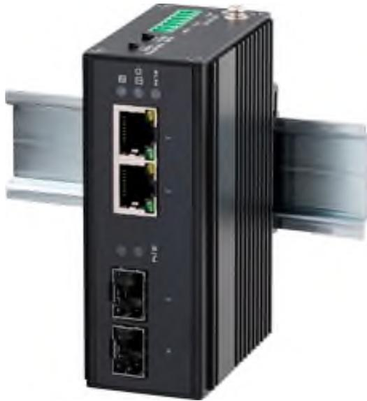
Промышленный полностью гигабитный PoE коммутатор NIS-3500-122PSG имеет 2 порта Ethernet 10/100/1000Base-T и 2 слота для установки оптических SFP модулей 1000/2500M для подключения к магистрали.
